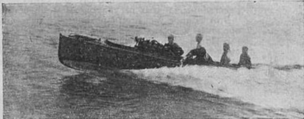
Малая моторная лодка типа „Viper“ с пробной установкой авиомотора „Холл-Скотт“ в 125 л. с. Скорость хода 50 км в час
